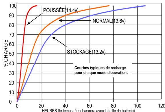
**14.4 Volts (Mode De Poussée)** A renvoyé la batterie à 90% de la pleine charge en approximativement 3 heures. La batterie a atteint la pleine charge en approximativement 11 heures.
