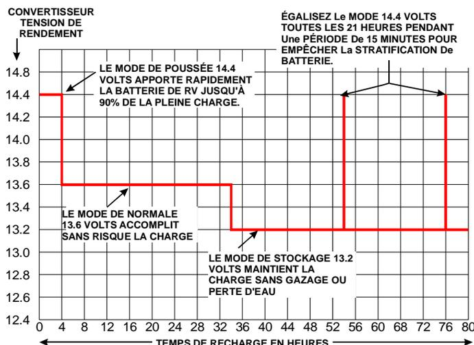
**"on" de lumière** - Indique que le convertisseur est en mode de poussée et la tension de rendement est de 14.4 volts continu pour recharger rapidement la batterie jusqu'à 90% de la pleine charge.
