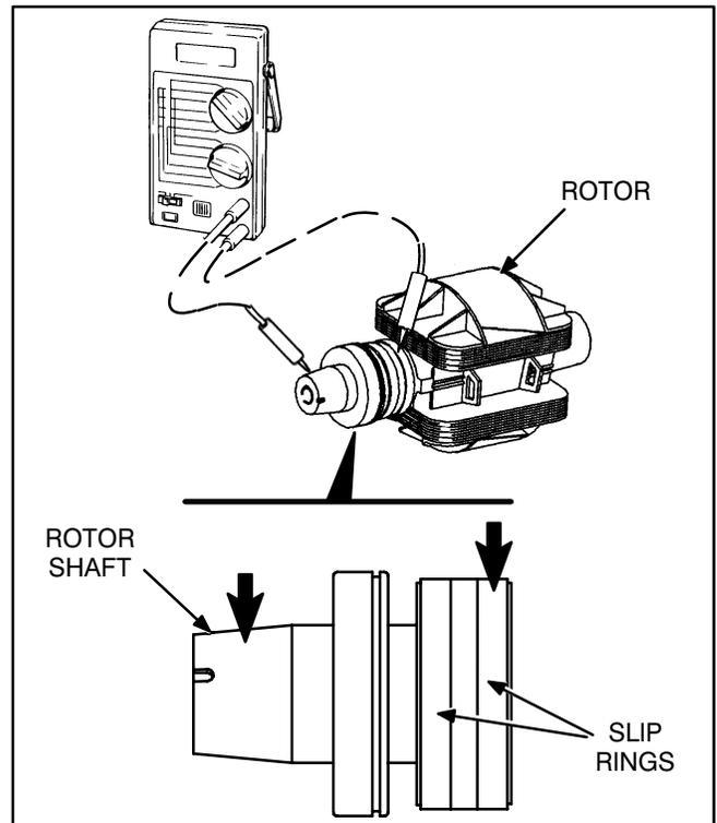
**FIGURE 7-8. GROUNDED ROTOR TEST**
