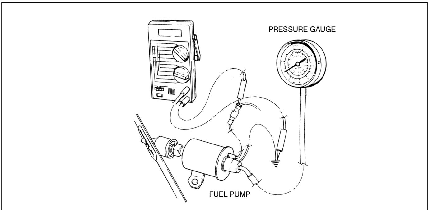
FIGURE 8-12. FUEL PUMP TEST
