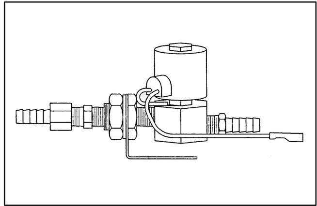
FIGURE 8-15. FUEL SOLENOID VALVE
