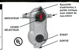
Le régulateur automatique à levier sélecteur Fairview Fittings dirige automatiquement le débit de gaz de pétrole liquéfié (GPL) de la bouteille de service vide désignée à la bouteille de réserve, sans interruption de service. Il est idéal pour les véhicules de plaisance (RV), les petits chalets et les camps de villégiature.
